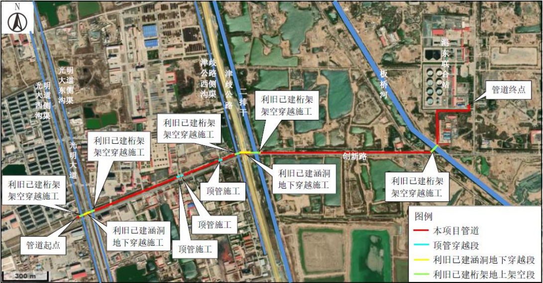
图2-3 管道路由及施工布置图
