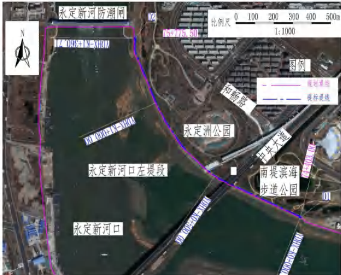
图 3.3.1.2-2 永定新河河口左堤段海堤堤标建设堤线布置图
