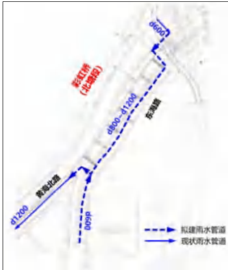
图 3.4-1 北塘段雨水管道布置示意图
