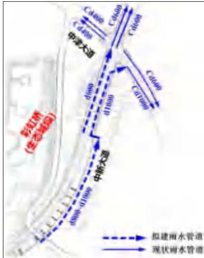
图 3.4-2 生态城段雨水管道布置示意图
