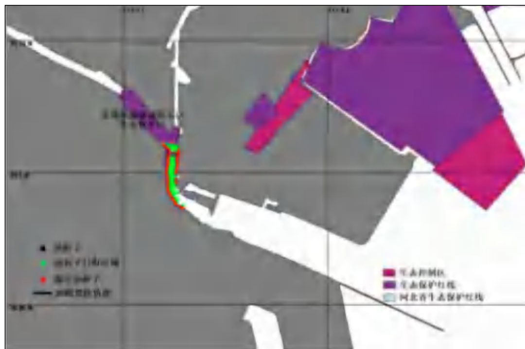
图 8.5-5 溢油代表点冬季北风落潮期持续下溢油情景模拟（泄漏3天后）
