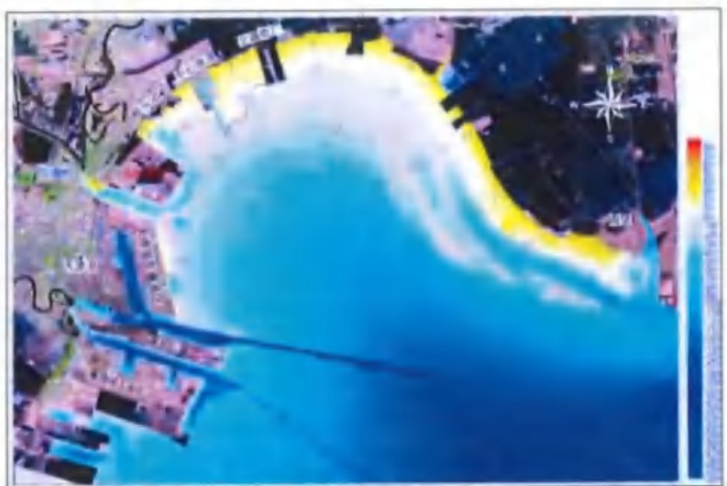
图 6.2-4 永定新河口海域地形 (河口北侧临海新城附近周边为2018年7月测图，理论基面高程)
