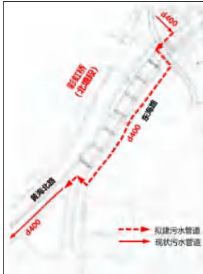
图 3.4-5 北塘段污水管道布置图
