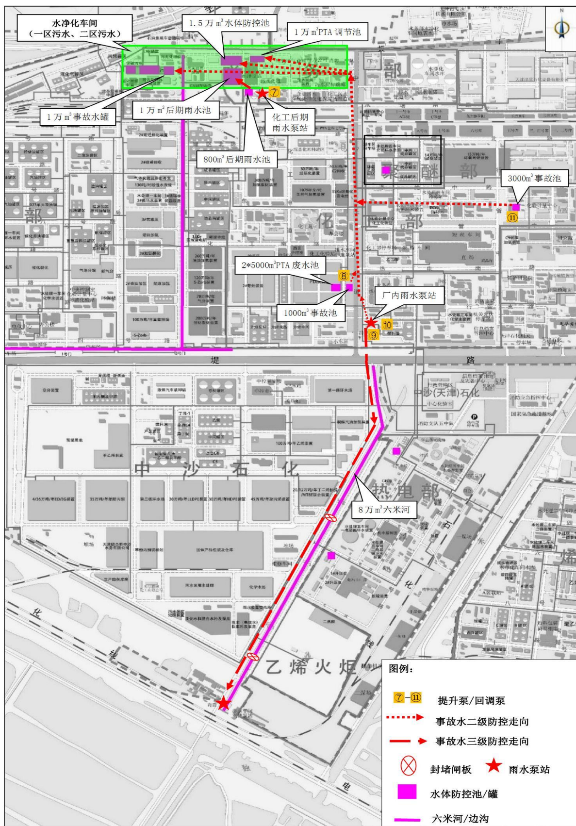
图 2.5-1 化工区事故水防控系统
