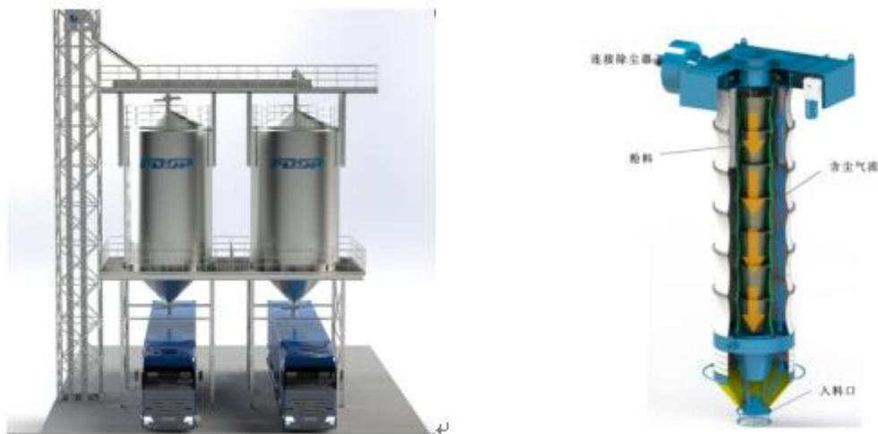
图 2-3 产品装车工序示意图
