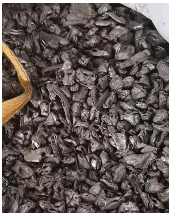
图 2.3-2 资源化产物金属铁块照片
