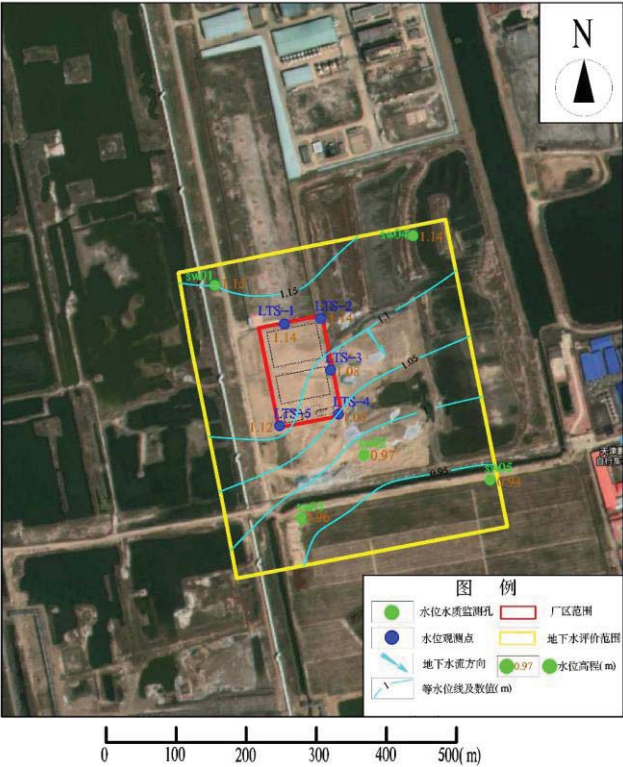
图 3.2-8 地下水现状监测点平面布置图
