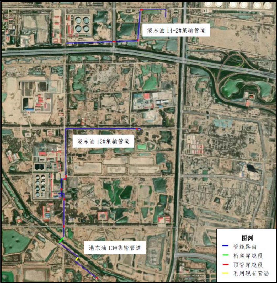
图4 本项目三条集输管道穿跨越位置图
