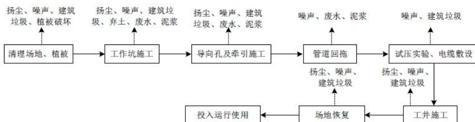
图 2-7 拉管敷设施工工艺流程图
