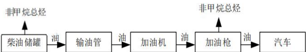
图 2-4 柴油卸油、储油、加油工艺流程及排污节点图
