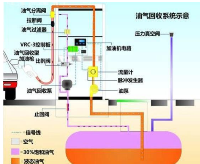
图 4-2 二次油气回收示意图
