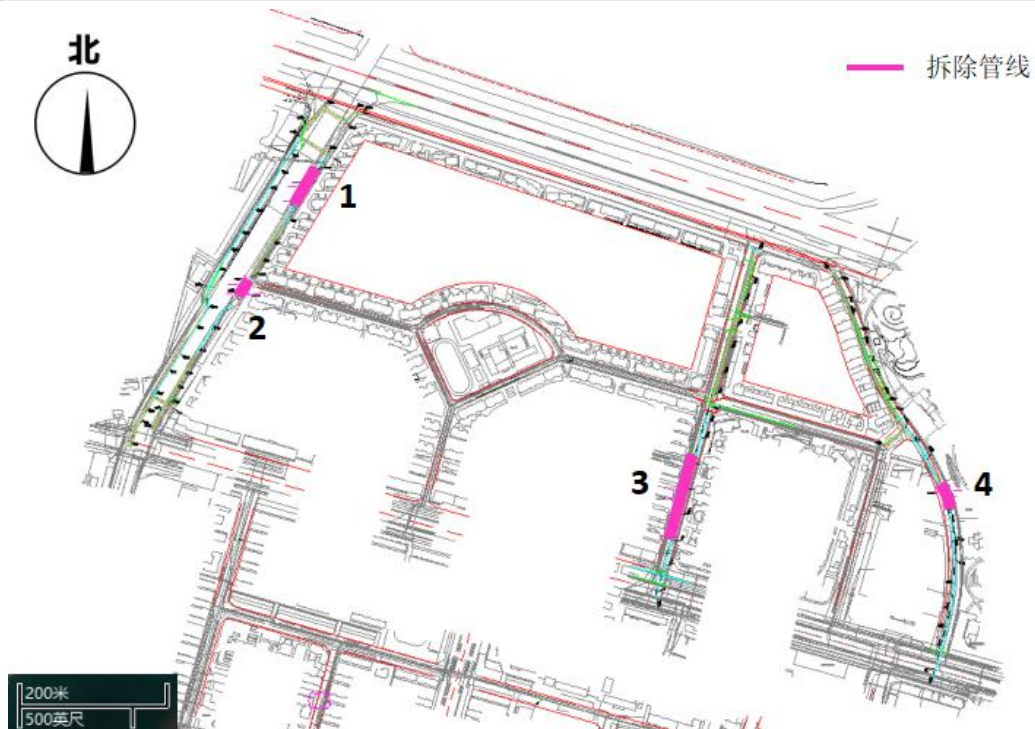
图 6 拆除管线示意图
