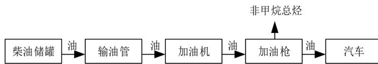
图 2-6 柴油加油工艺流程和产排污节点图
