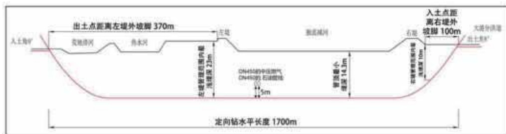
图 2-5 项目穿越独流减河段纵断面设计图
