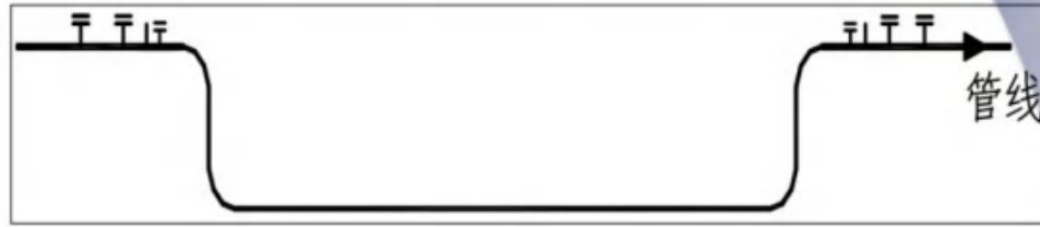
图 2-9 四点不停输封堵工艺（五）
