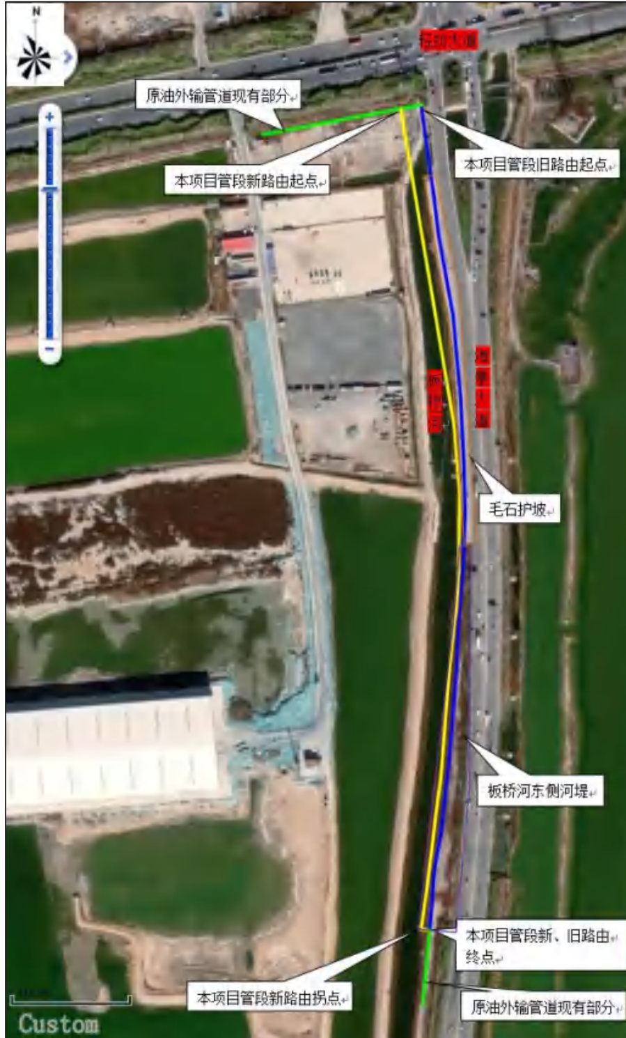
图 2-2 本项目新建管段路由与旧路由示意图
