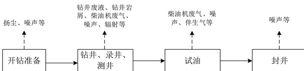
图 4 勘探井施工期工艺流程
