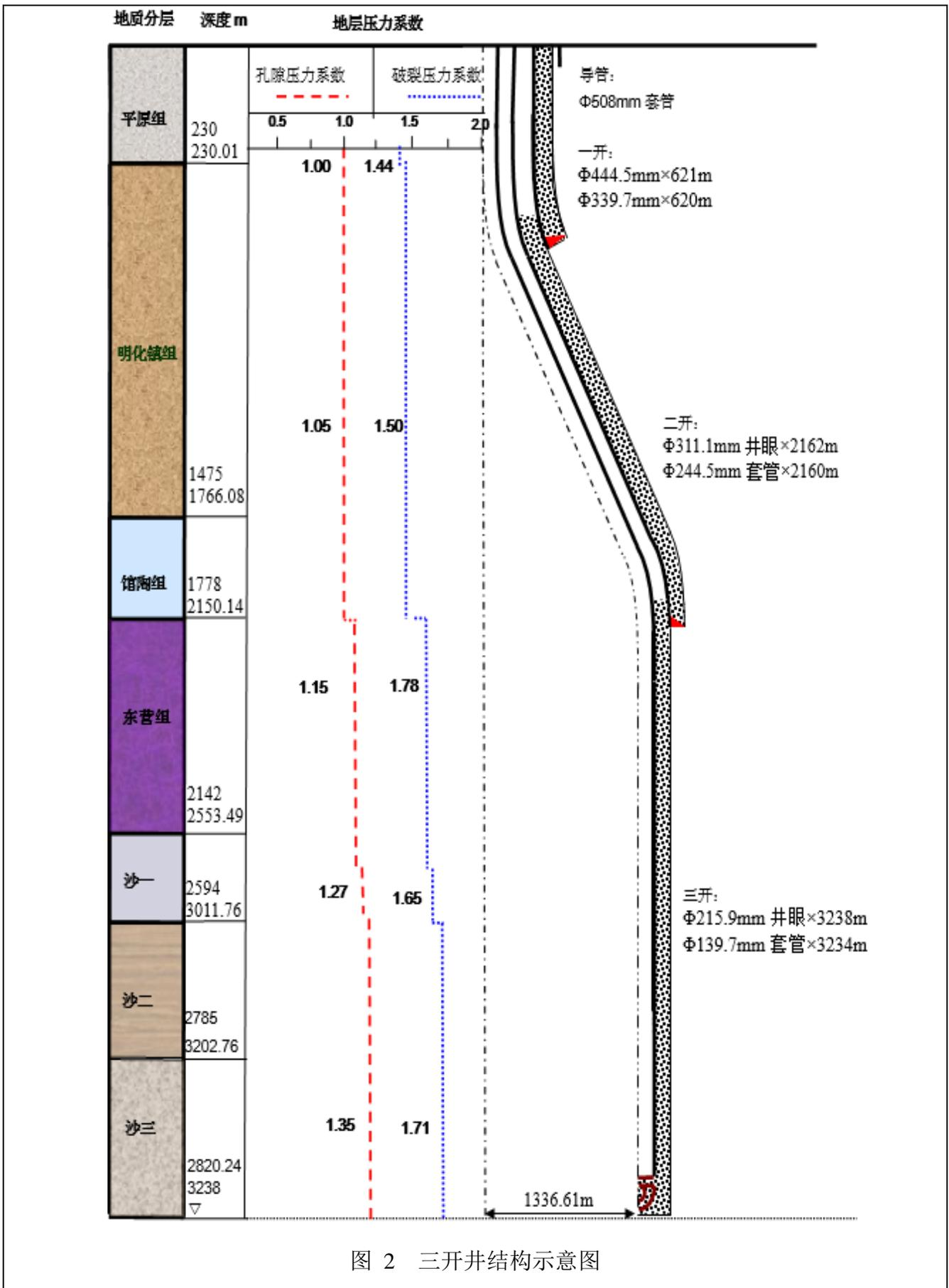
图 2 三开井结构示意图
